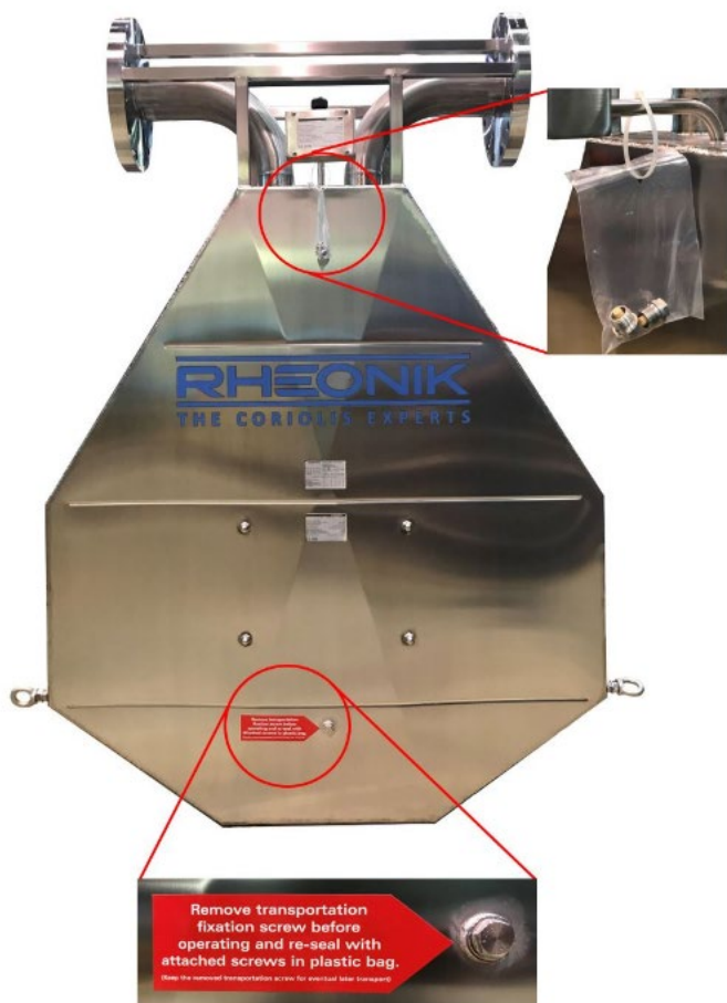
Abbildung 6: Transportbefestigungsschrauben und Stopfen
